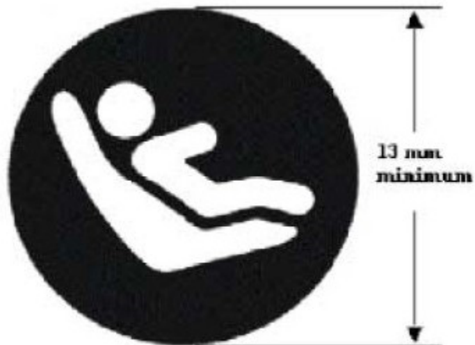
Figure 10 — Symbole du dispositif universel d'ancrages d'attaches inférieures
